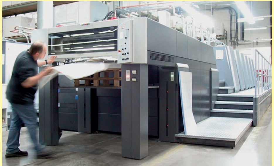
Hochglanz ohne UV – mit einem neu entwickelten Dispersionslack schafft Griebisch & Rochol glänzende Ergebnisse auf einer Speedmaster XL 105.
